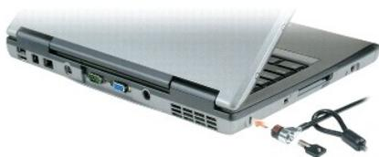
**connecteur IEEE 1394** — Permet de relier des périphériques qui prennent en charge des vitesses de transfert ultra rapides IEEE 1394, par exemple des caméras vidéo numériques.
